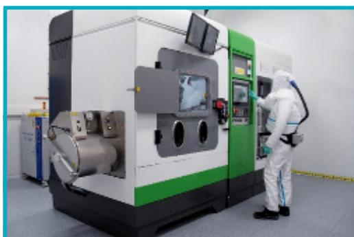
Machine de fabrication additive métallique
