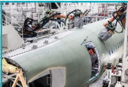
Robots d'assemblage Airbus (Hambourg)
